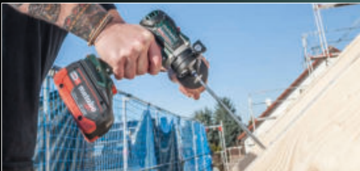
A biték és hatlap fúrószárok közvetlenül az tengelybe helyezhetők. Ideális alkalmazás szűk helyeken.
