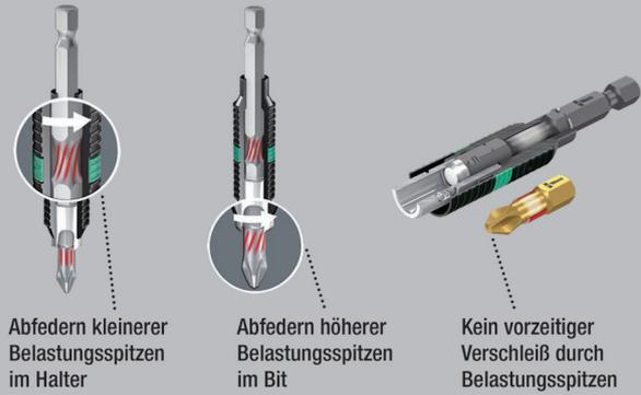
Universalhalter für die Aufnahme von Bits mit 1/4"-Außensechskantantrieb nach DIN ISO 1173-C 6,3 und E 6,3 (ISO 1173). BiTorsion-Halter von Wera haben eine Torsionsfeder, die kleinere Belastungsspitzen beim Verschrauben aufnimmt.
