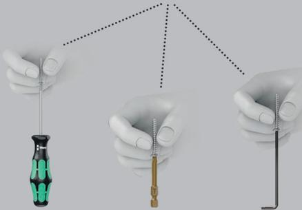
Bits für Innen TORX® Schrauben. Durch die aus der Flächenpressung zwischen der Abtriebsspitze und Schraubenprofil resultierende Klemmkraft werden die Schrauben sicher auf dem Werkzeug gehalten. 1/4"-Sechskant, passend für Halter nach DIN ISO 1173-D 6,3.
