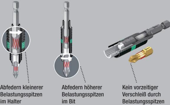
BiTorsion Bits für Sechskant-Schrauben mit elastischer Torsionszone, in die bei Belastungsspitzen kinetische Energie abgeleitet wird. Mit weicherer BiTorsionzone zur Vermeidung des Verwindens der Bit-Spitze bei hohen Belastungen.
