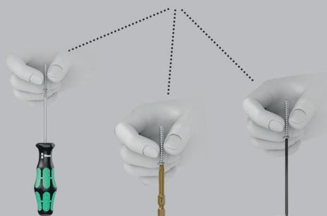
Die von Wera entwickelten TORX® HF (HF = Haltefunktion) Werkzeuge zeichnen sich durch eine geometrische Optimierung des ursprünglichen TORX® Profils aus. Durch die aus der Flächenpressung zwischen der Abtriebsspitze und Schraubenprofil resultierende Klemmkraft werden die Schrauben sicher auf dem Werkzeug gehalten! 1/4"-Sechskant, passend für Halter nach DIN ISO 1173-F 6,3.
