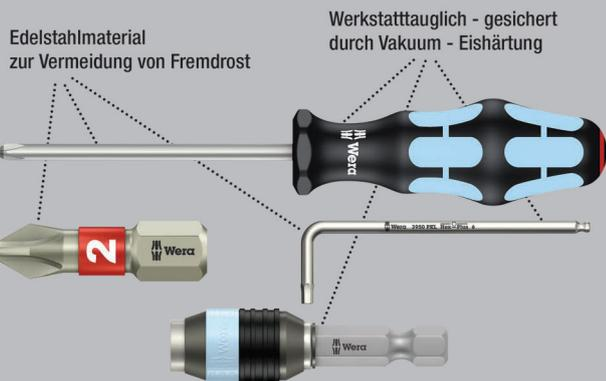
Hochwertige Bits aus Edelstahl für Innen TORX® Schrauben. Wera Edelstahl Werkzeuge werden aus Edelstahl gefertigt, wodurch der unansehnliche Fremdrost vermieden wird. 1/4"-Sechskant, passend für Halter nach DIN ISO 1173-F 6,3.
