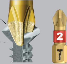
Bits mit winzigen Diamantpartikeln auf der Bit Spitze. Diese sorgen für sicheren Sitz in der Schraube, reduzieren den benötigten Anpressdruck und reduzieren die Gefahr des Abrutschens. BiTorsion Bits mit elastischer Torsionszone, in die bei Belastungsspitzen kinetische Energie abgeleitet wird. Mit weicherer Bit-Torsionszone zur Vermeidung des Verwindens der Bit-Spitze bei hohen Belastungen. Dadurch signifikante Erhöhung der Produktlebensdauer.
