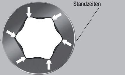
Hex-Plus bietet größere Anlageflächen im Schraubenkopf. Die Kerbwirkung wird dadurch auf ein Minimum reduziert, die Zerstörung des Schraubenkopfes nahezu eliminiert.
